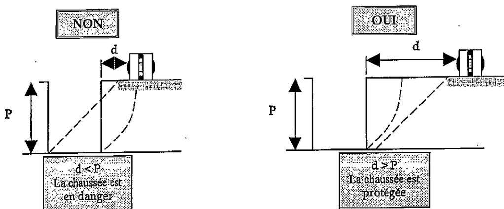
Les tranchées sont creusées verticalement, leur profondeur, outre les contraintes d'implantation liées aux raccordements des réseaux sur l'existant et aux croisements de canalisations, doit respecter les conditions de couverture inscrites dans les normes et règlements en vigueur.
