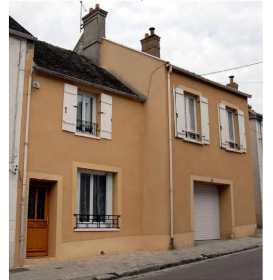
A l'occasion des travaux de ravalement de façade, les différences de texture ou de coloration d'enduit seront conservées ou restaurées. Ainsi, la couleur de la tapisserie sera plus foncée que celle des modénatures. Le soubassement sera plus foncé que la tapisserie générale. Les enduits devront être de préférence colorés dans la masse par des terres naturelles.
