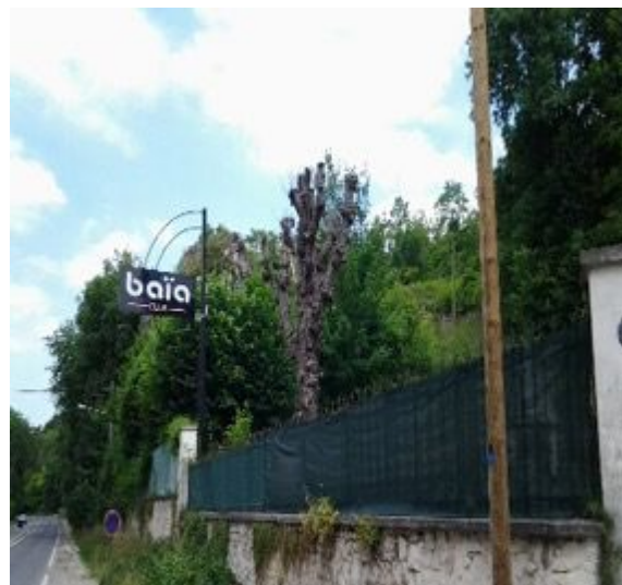
Enseigne scellée au sol installée à moins de la moitié de sa hauteur d'une limite séparative de propriété, Nemours, Septembre 2019
